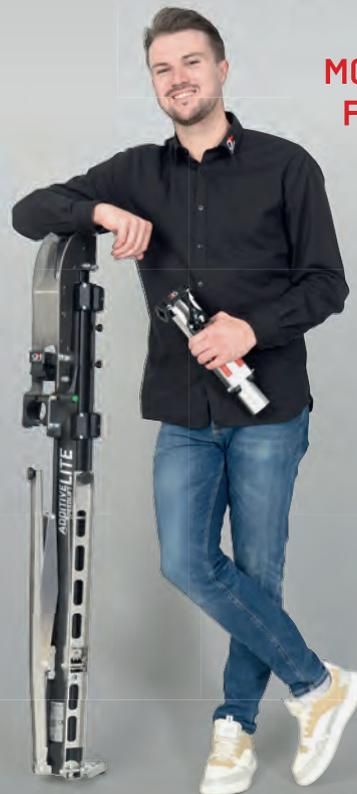
Der Additive Speedlift LITE ist ein gasdruckgestützter Montageständer mit Halteklau. Auf Knopfdruck wird eine Kraft von ca. 180 N freigegeben und schwere E-Bikes werden mit geringer Anstrengung sekunden-schnell in die gewünschte Position gebracht. Leichte Räder hingegen schweben sogar von allein nach oben. Zum Absenken ist hierbei lediglich leichte Zugkraft nach unten erforderlich.
