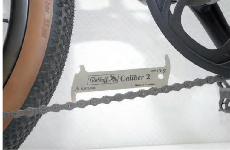
^ **Mit einer Kettenmesslehre** lässt sich der Verschleiß der Kette prüfen. Sinkt die Nase komplett ein, ist die Verschleißgrenze erreicht. Im Bild ist noch alles in Ordnung.
