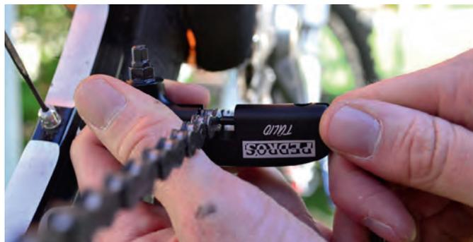
^ Ein Kettennierer gehört in die Werkzeugkiste, will man Ketten selbst wechseln.
