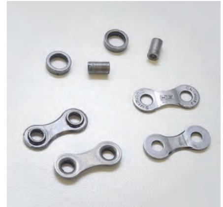
behandlung entscheidet mit über die Verschleißfestigkeit einer Kette. Die Unterschiede im Produktionsaufwand schlagen sich in den Preisen nieder, die sich zwischen unter zehn und über sechzig Euro pro Kette bewegen, im Einzelfall auch mehr.
